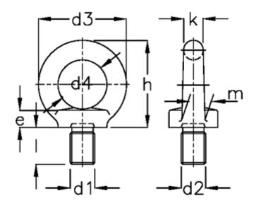
$$\begin{array}{lll} d1 = M12 & K = 12 \\ d2 = 30 & I = 20.5 \\ d3 = 54 & m = 14 \\ d4 = 30 & e = 10 \end{array}$$
